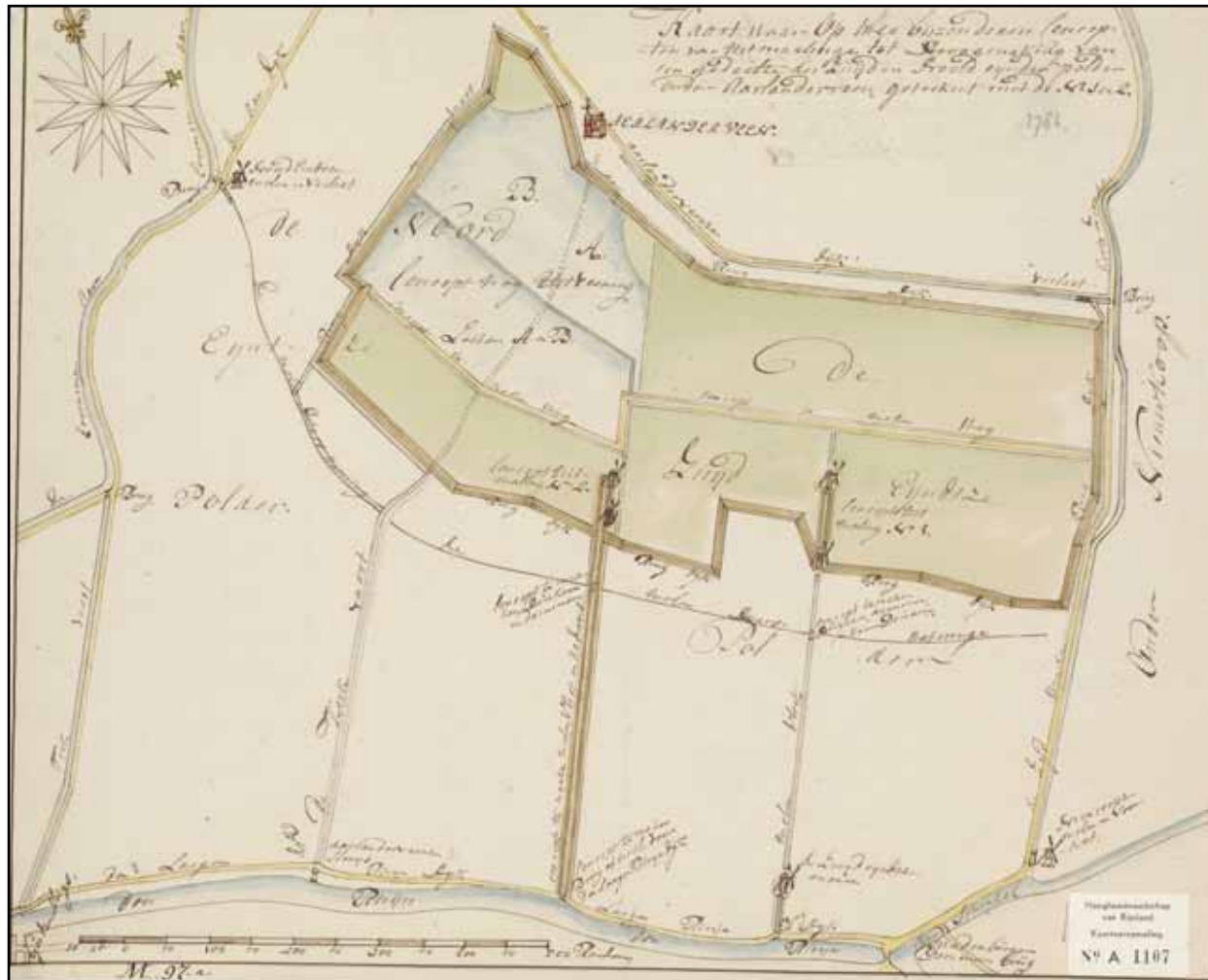
Het in 1784 opgestelde bemalingsplan voorzag in twee mogelijkheden van molenbouw; twee vijzelmolens die direct op de Rijn zouden uitmalen, of twee schepadmolens die dat via de molenvliet van de bestaande Zuideindermolen zouden doen. Op de kaart is ook de loop van de Kerkvaart van de Rijn tot de kerk nog te zien. (collectie hoogheemraadschap van Rijnland)
